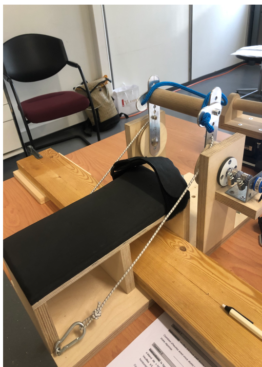
Figure 6. La position de la poignée était calculée par un potentiomètre (6639S-1-103, résistance 10 kOhm, Bourns Inc, Riverside, CA, USA), et une application écrite sur mesure en Python faisait bouger un curseur verticalement par rapport à la position de la poignée. Si les sujets descendaient la poignée le curseur montait. Si les sujets montaient la poignée, le curseur descendait. L'application proposait plusieurs modes. Le premier était d'afficher une ligne horizontale, afin que les sujets effectuent une légère flexion du poignet. Ce mode a été utilisé pour la mesure du AMT, les séries de stimulations pour calculer la CSP, et les séries de stimulation en activité. Pour le calcul de la CSP, le poids a été accroché à la corde bleue afin d'avoir une plus forte contraction. Dans un autre mode, le curseur avançait le long d'une ligne. Ce deuxième mode a été utilisé pour les séries pendant la tâche et pour la tâche visuomotrice.
